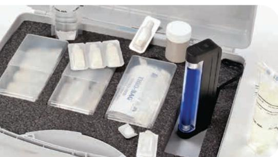
Las bacterias coliformes y el *E.coli* son buenos indicadores de una contaminación bacteriana general y, gracias a su sencilla sensibilidad de detección, bacterias indicadoras ideales para la supervisión de cursos de agua, depósitos y tuberías. En las directivas de la OMS para la calidad del agua potable se indica un contenido de cero unidades formadoras de colonias (UFC) de bacterias coliformes y *E.coli* por muestra de agua de 100 mL.
