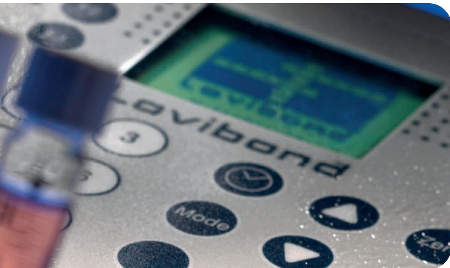
El MultiDirect es un fotómetro moderno, controlado por microprocesador, con tastatura ergonómica y un gran display gráfico. Posee una gran cantidad de métodos preprogramados basados en la acreditada gama de tabletas reactivas, reactivos líquidos, test de cubetas y reactivos en polvo (VARIO- Powder Packs) Lovibond®. El usuario puede además memorizar métodos propios.
