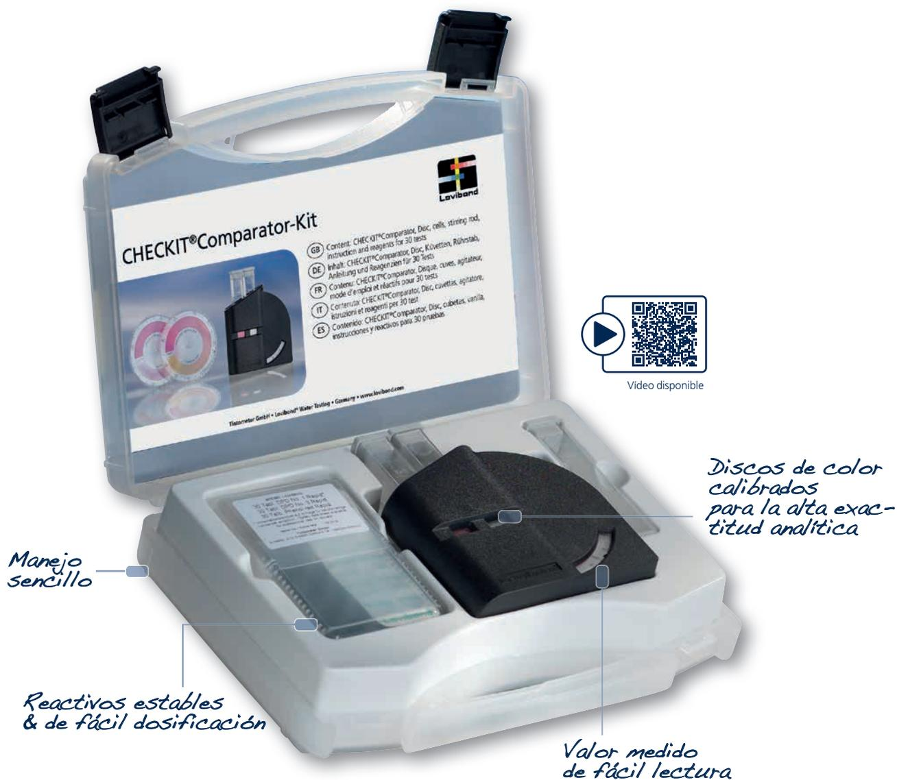
Los kits de análisis de comparadores CHECKIT® son kits de análisis de agua precisos y fáciles de usar. Simplemente, coloque el reactivo en la cubeta, gire el disco hasta que el color coincida con el de la muestra de agua preparada y lea el valor de concentración.
