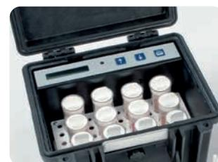
El incubador **DI10** permite una incubación fiable de las laminillas bacterianas in situ, en el laboratorio o incluso en la carretera en el coche.
