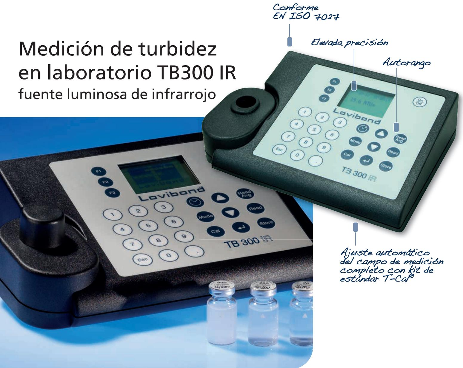
La turbidez se determina Nefelométricamente según la norma EN ISO 7027 (luz dispersa 90°). La fuente luminosa de infrarrojos permite la medición de pruebas coloreadas y no coloreadas.
