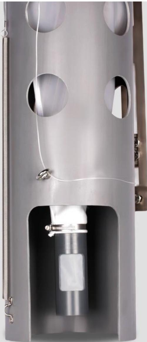
Las redes de plancton Bottle net tienen su parte superior e inferior fabricada en lona resistente. El cuerpo de la red está fabricado en malla Nitex. El extremo inferior de la red está diseñado para colocar nuestros colectores de plancton CP3-50B especiales para la Bottle net. Son redes de forma cónico-cónica diseñadas para una eficiencia de filtración óptima a velocidades  $<1\text{m/s}$ .
